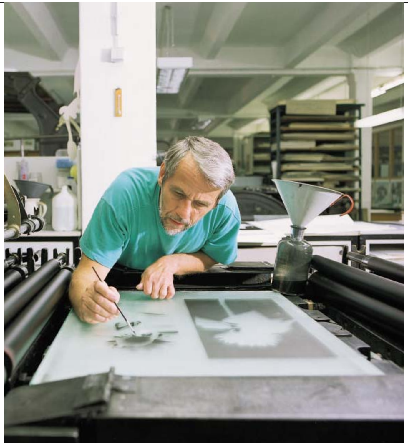
⑥ Die Platte liegt bereits in der Druckmaschine, dort wird sie noch einmal bearbeitet, um auch die letzten Feinheiten sichtbar zu machen. Von der Platte wird die Farbe dann direkt an das Papier gegeben. Das Runzelkorn der gehärteten Gelatine ist feiner als jedes Druckraster, etwa beim Offsetdruck. Die Reproduktion erreicht eine extreme Nähe zum Original – ein Faksimile entsteht
