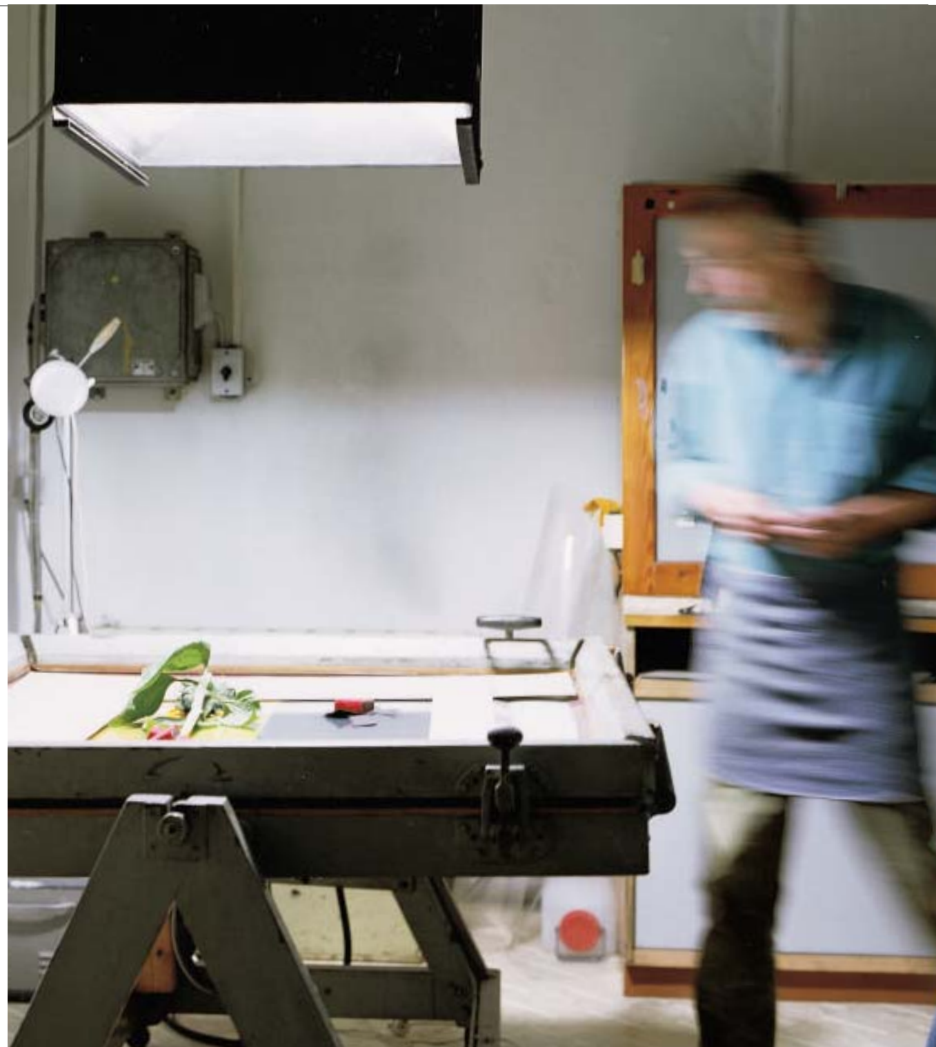
③ Die Blume wird im Kopierrahmen belichtet. Durch das Licht härtet die Gelatinemischung nun teilweise, diesen Vorgang nennt man Gerbung. Je stärker eine Stelle gerbergt ist, desto weniger Feuchtigkeit – sprich umso mehr Farbe – kann sie aufnehmen
