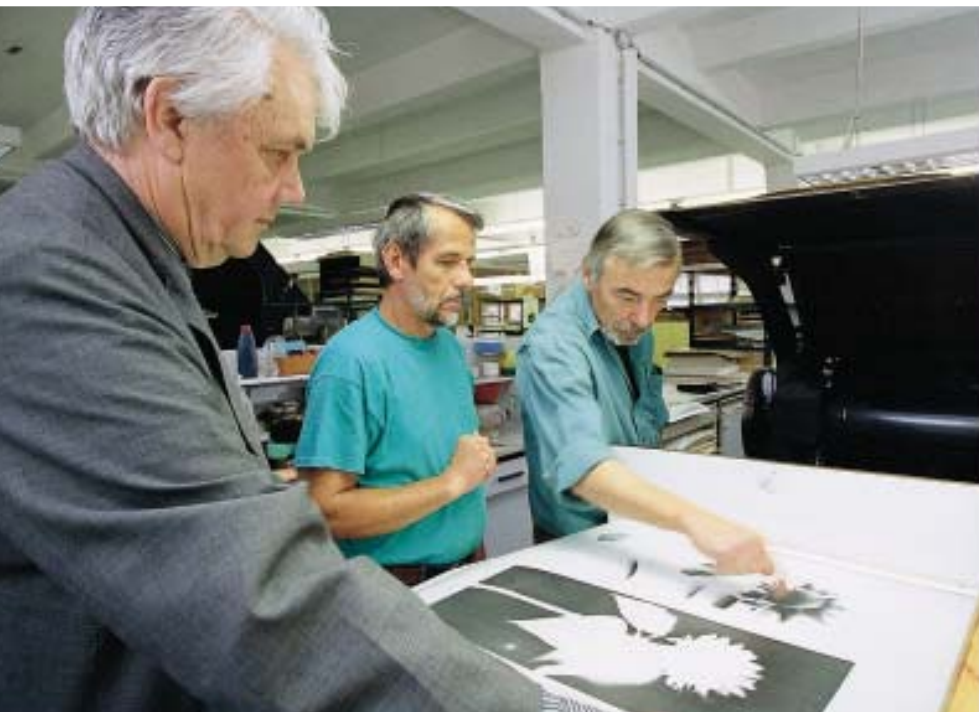
⑦ Bevor die endgültige Auflage gedruckt wird, kann anhand von Andruck die Qualität und Feinheit der Wiedergabe kontrolliert werden. Die beiden Drucker: Winfried Hoffmann (Mitte) und Udo Scholz
