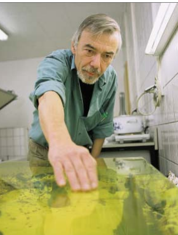
① Eine Glasplatte wird mit lichtempfindlicher Chromatgelatine beschichtet. Die Substanz wird normalerweise mittels eines Fotonegativs des zu reproduzierenden Originals belichtet und härtet je nach dessen Dichtwerten mehr oder weniger
